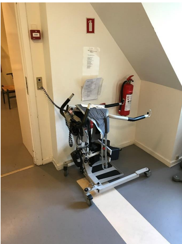
Figur 12: Opladning af elektriske hjælpemidler i flugtvejsgang (6.5.1 stk. 3)
